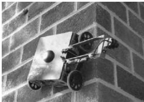
图 1 轮式爬壁机器人
