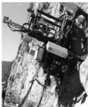
图4 导轨式爬壁机器人
