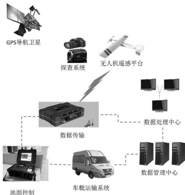
图1 无人机遥感系统基本组成
