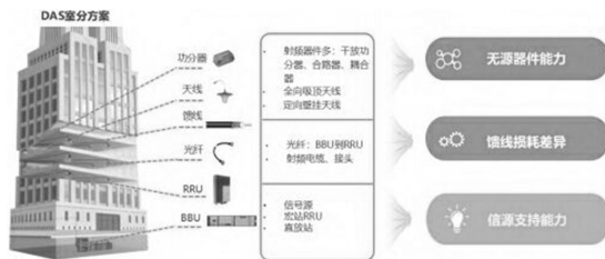
BBU-基带单元;DAS-分布式天线系统;RRU-射频拉远单元。
