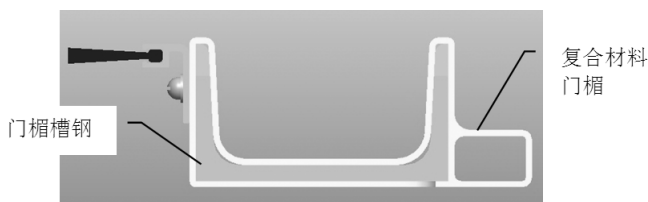
图6 复合材料门楣截面
