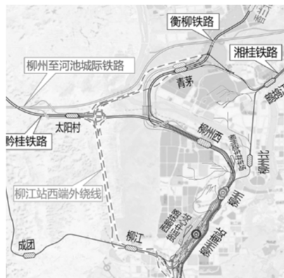
图 2 基于集装箱直通货流特征的货车外绕线方案
