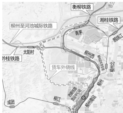
图 1 原柳州铁路枢纽货车外绕线方案
