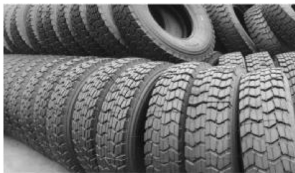
图 2 全翻新载重汽车钢丝子午线轮胎
