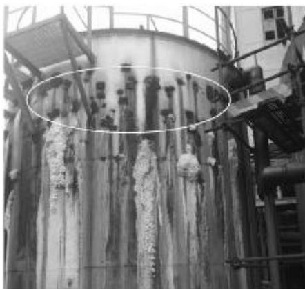
图1 前反应桶水线腐蚀
