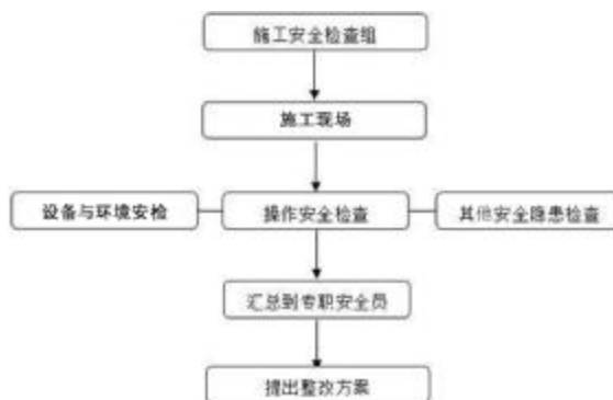
图2 施工安全检查组工作流程
