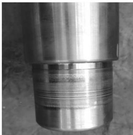
图 3 轴与轴承磨损损伤轴
