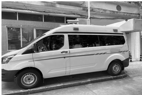
图1 某型号的路面多功能检测车
