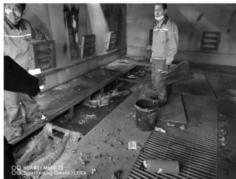
图 2 烤漆房底部金属网格及防尘棉
