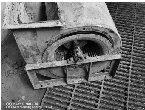
图3 环保设备抽气叶轮片
