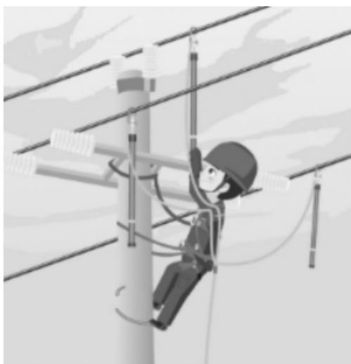
图 1 人体碰触 10kV 接地线错误做法
