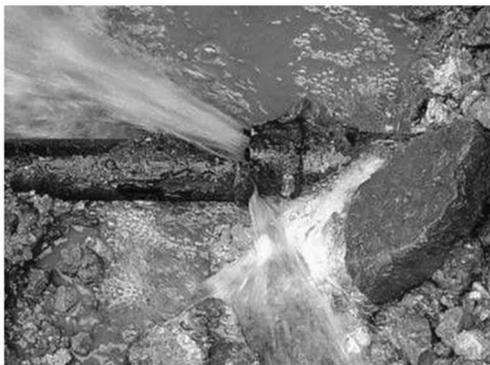
图4 自来水管网漏水问题
