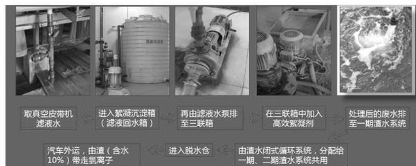
图 2 脱硫废水处理优化流程
