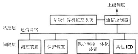
图1 变电站分散测控系统
