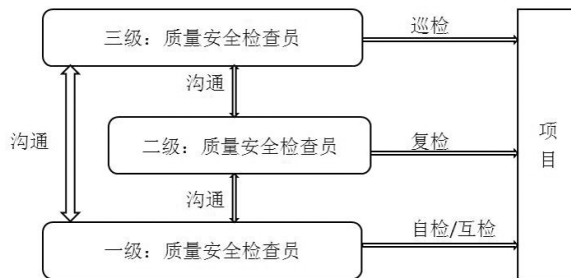
图 3 施工质量安全检查体系
