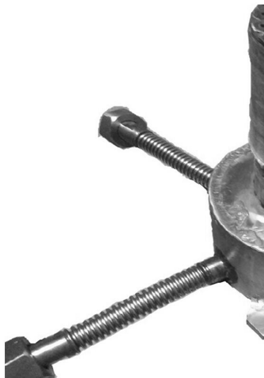
图6 感应熔炼用水冷铜坩埚实物局部钎料的优化作用。
